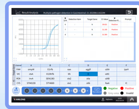
Рисунок 3: Положительная стандартная кривая амплификации и анализ результатов (желудочно-кишечный тракт 21 тип)
